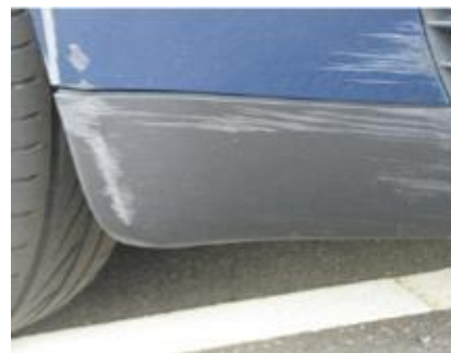
Niet acceptabel, door de lak heen
